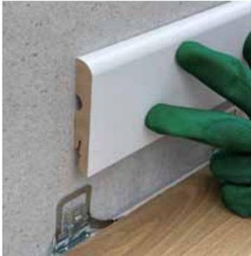
Das Befestigungssystem „FN Clipholder CH25“ kann ohne Werkzeug und ohne Bohren in die Dehnfuge zwischen Boden und Wand eingespannt werden. Durch die Druckkraft des Bodens wird die Leiste an der Wand gehalten. Fotos: FN Neuhofer (2)
